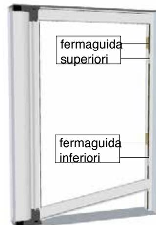
**7** Far scorrere i fermaguida inferiori fino a bloccare la guida inferiore, serrare la vite.
